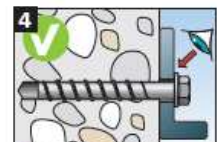
4 Nach dem Anschrauben darf kein leichtes Weiterdrehen der Schraube möglich sein. Der Schraubenkopf muss auf dem Anbauteil aufliegen und darf nicht beschädigt sein.
