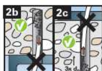
2b 2c Le nettoyage du trou de perçage n'est pas nécessaire lors du perçage vertical vers le haut ou vers le bas. Dans ce cas, augmentez toutefois la profondeur du trou de
