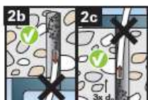
Het schoonmaken van het boorgat kan achterwege blijven wanneer verticaal naar boven of beneden wordt geboord. Vergroot de boordiepte in dat geval echter met 30 mm.
