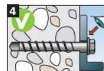
Na het vastschroeven mag het niet mogelijk zijn de schroef licht verder te draaien. De schroefkop moet op het bevestigingsdeel rusten en mag niet beschadigd zijn.
