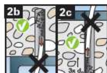
2b 2c Le nettoyage du trou de perçage n'est pas nécessaire lors du perçage vertical vers le haut ou vers le bas. Dans ce cas, augmentez toutefois la profondeur du trou de
