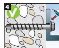
4 Après le vissage, il ne doit pas être possible de tourner légèrement la vis. La tête de vis doit reposer sur l'accessoire et ne doit pas être endommagée.
