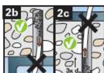
Het schoonmaken van het boorgat kan achterwege blijven wanneer verticaal naar boven of beneden wordt geboord. Vergroot de boordiepte in dat geval echter met 30 mm.
