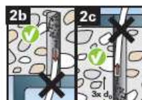
Die Reinigung des Bohrlochs darf entfallen, wenn senkrecht nach oben oder unten gebohrt wird. Bohrlochtiefe dann jedoch um 30mm erhöhen.
