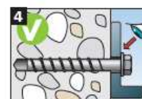
Na het vastschroeven mag het niet mogelijk zijn de schroef licht verder te draaien. De schroefkop moet op het bevestigingsdeel rusten en mag niet beschadigd zijn.
