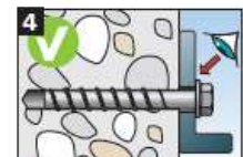
4 Nach dem Anschrauben darf kein leichtes Weiterdrehen der Schraube möglich sein. Der Schraubenkopf muss auf dem Anbauteil aufliegen und darf nicht beschädigt sein.
