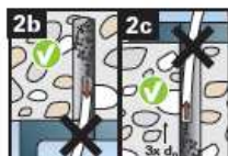
2b 2c Le nettoyage du trou de perçage n'est pas nécessaire lors du perçage vertical vers le haut ou vers le bas. Dans ce cas, augmentez toutefois la profondeur du trou de perçage de 30 mm.
