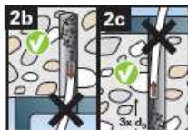
2b 2c Het schoonmaken van het boorgat kan achterwege blijven wanneer verticaal naar boven of beneden wordt geboord. Vergroot de boordiepte in dat geval echter met 30 mm.
