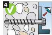
4 Na het vastschroeven mag het niet mogelijk zijn de schroef licht verder te draaien. De schroefkop moet op het bevestigingsdeel rusten en mag niet beschadigd zijn.
