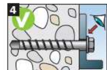
4 Na het vastschroeven mag het niet mogelijk zijn de schroef licht verder te draaien. De schroefkop moet op het bevestigingsdeel rusten en mag niet beschadigd zijn.
