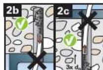
2b 2c Het schoonmaken van het boorgat kan achterwege blijven wanneer verticaal naar boven of beneden wordt geboord. Vergroot de boordiepte in dat geval echter met 30 mm.
