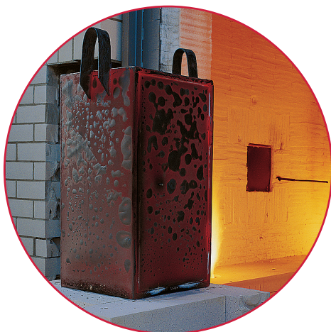
Brandschutzschrank nach Test im FORMAT Testlabor Fire storage unit after a test in the FORMAT fire protection laboratory
