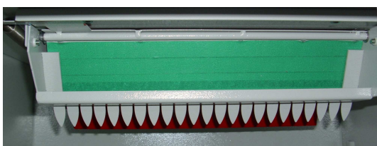
Terugloopblokkering vrij (normale positie)
