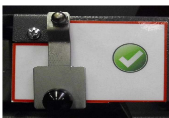
Dispositif anti-retour libre (position normale)
