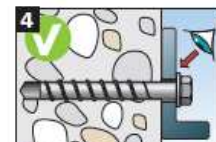
Nach dem Anschrauben darf kein leichtes Weiterdrehen der Schraube möglich sein. Der Schraubenkopf muss auf dem Anbauteil aufliegen und darf nicht beschädigt sein.
