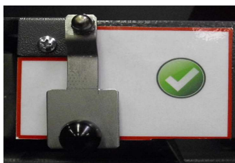
Terugloopblokkering vrij (normale positie)
