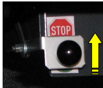
Rückholsperre gesperrt (ausgelöst)
