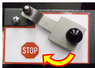
Rückholsperre gesperrt (ausgelöst)
