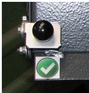
Terugloopblokkering vrij (normale positie)
