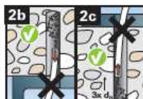
2b 2c Le nettoyage du trou de perçage n'est pas nécessaire lors du perçage vertical vers le haut ou vers le bas. Dans ce cas, augmentez toutefois la profondeur du trou de perçage de 30 mm.
