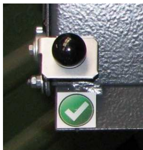
Dispositif anti-retour libre (position normale)
