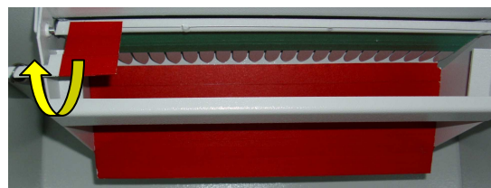
Rückholsperre gesperrt (ausgelöst)
